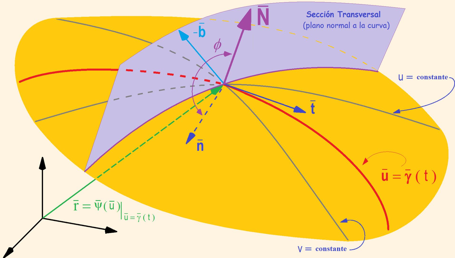
**CURVA TRAZADA SOBRE UNA SUPERFICIE – SECCIÓN TRANSVERSAL**
