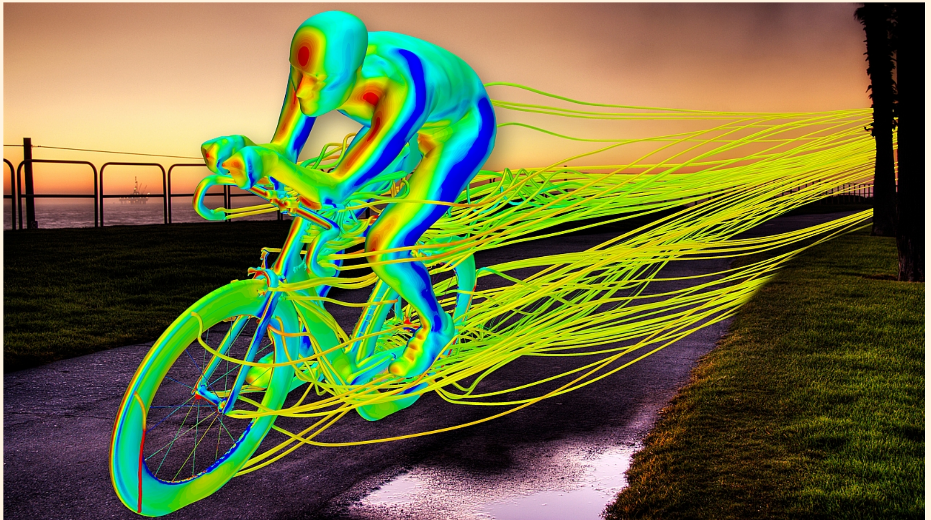
Presión y líneas de corriente producidas por un ciclista Imagen por cortesía de www.cd-adapco.com
