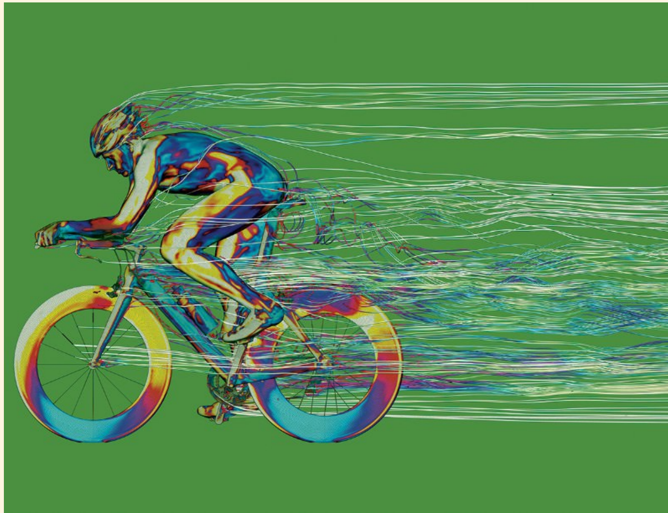
Presión y líneas de corriente producidas por un ciclista Imagen por cortesía de www.shu.ac.uk/research/cser
