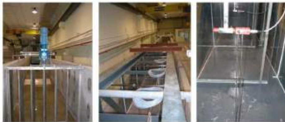
Figura 17. Canal de hidráulica fluvial. Vistas desde aguas abajo, aguas arriba y detalle de uno del ensayo de escalas de hendidura vertical
