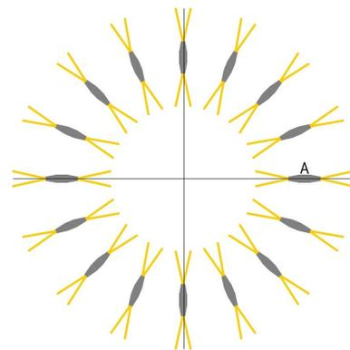
**Figura 2:** Esquema de la planta de la estructura a diseñar indicando la posición de los elementos verticales imitando el diseño de la terminal 4.
