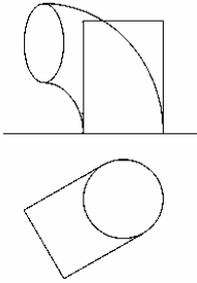
1.- Un cilindro recto de revolución de 100 mm de altura y radio  $r_c=35\text{mm}$ , se apoya por uno de sus extremos en el plano horizontal de proyección, el centro de la circunferencia de base es el punto  $A(87,63,0)$ .
