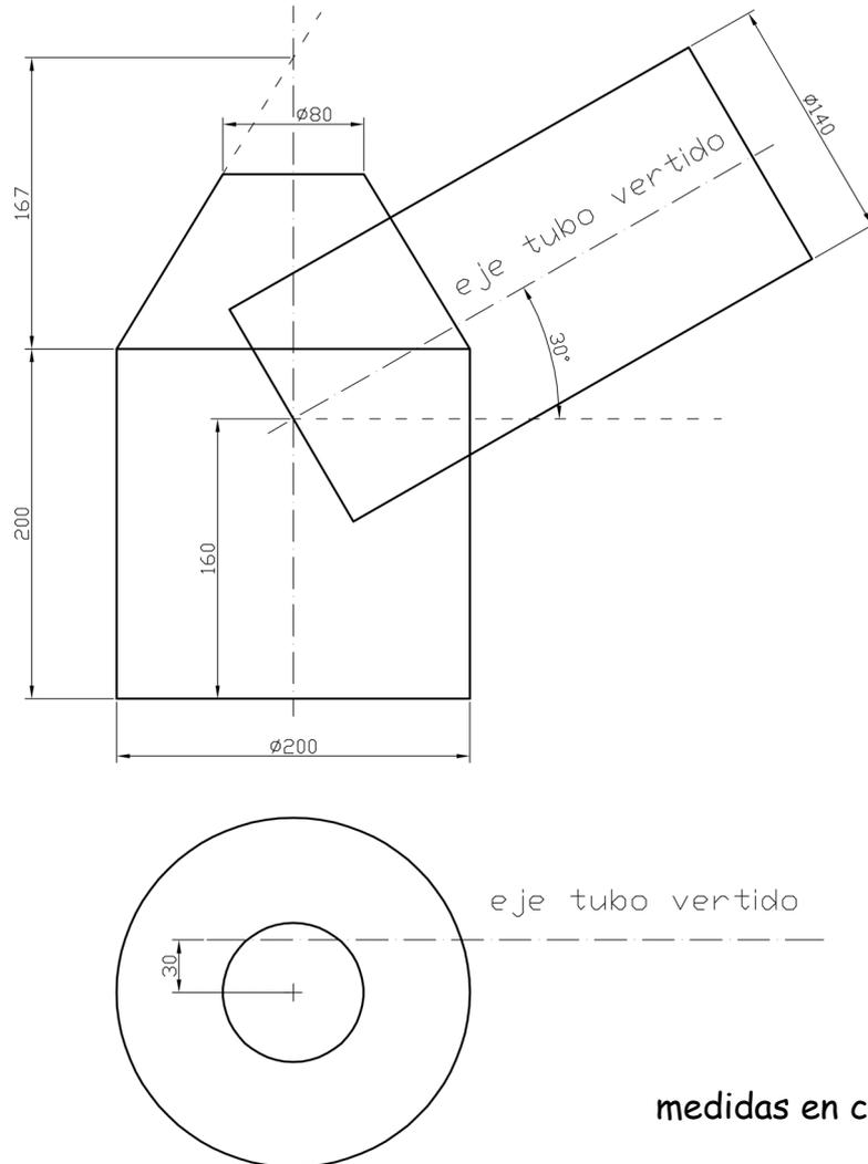
1.- Determinación de la intersección de los tres elementos, Cilindro de base, tronco de cono superior y entronque cilíndrico inclinado.
