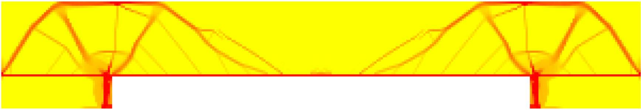
Figura 18. Diseño óptimo obtenido para el problema del puente colgante.
