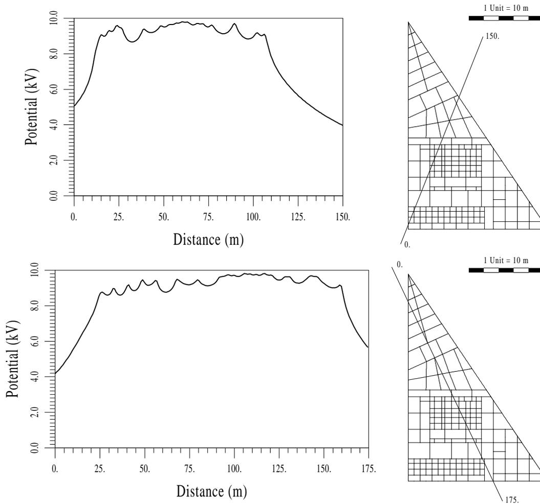
**Fig. 3.**—Subestación E.R. Barberá: Perfiles de potencial en la superficie del terreno a lo largo de diferentes líneas.
