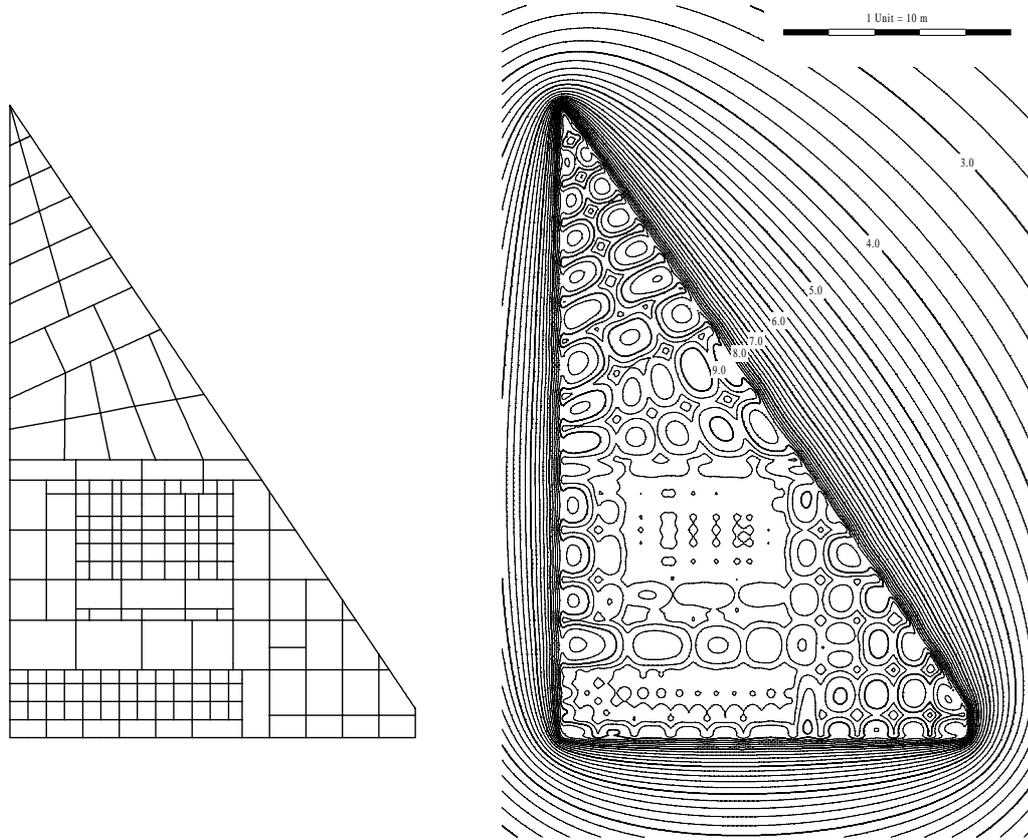
**Fig. 2.**—Subestación E. R. Barberá: Malla de electrodos y Distribución del potencial en la superficie del terreno (se han dibujado las líneas con incrementos de 0.2 kV y, en negrita, cada 1 kV).
