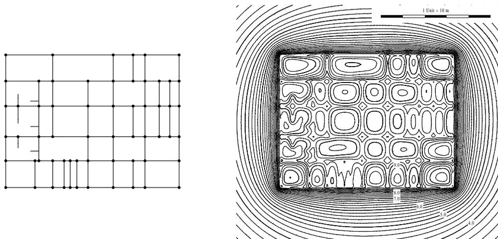
**Fig. 4.**—Subestación Balaidos II: Malla de electrodos (se indica con puntos negros la situación de los electrodos verticales) y Distribución del potencial en la superficie del terreno (se han dibujado las líneas con incrementos de 0.2 kV y, en negrita, cada 1 kV).
