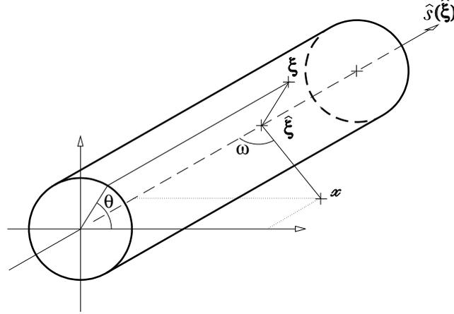
**Fig. 1** – Distancia entre un punto dado  $\mathbf{x}$  y un punto arbitrario  $\boldsymbol{\xi}$  de la superficie del electrodo.
