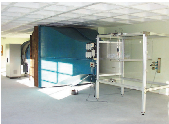
Túnel de viento en la E.T.S. de Ingenieros de Caminos, C. y P.
